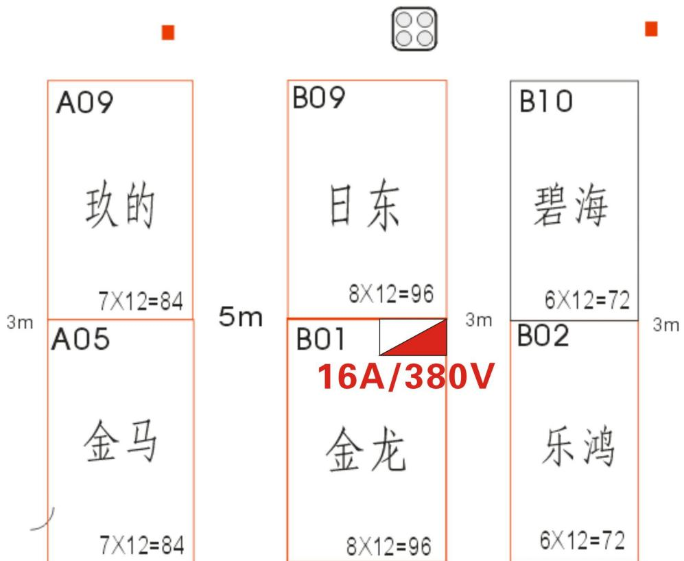
注：标示电箱位置时需要把周边的展位也截取出来作为参照物，申请两个电箱的需将两个电箱位置分贝标示，并将电箱功率与图示标识在一个位置上。
